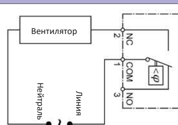
Вентилятор системы осушения воздуха
